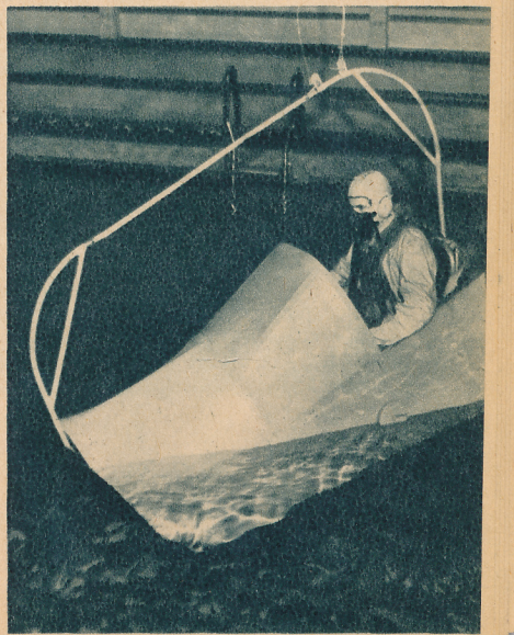
Syrgasmasken kan användas som »dykardräkt» vid en eventuell nödlandning på vatten. Försöket demonstrerades vid officersexamen på kadettskolan i Uppsala och nedan ses en kadett på väg ner i den specialbyggda atrappen, som konstruerats av löjtnant Edman.
