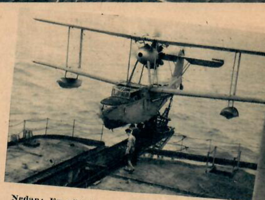
Nedan: En närbild av den kraftiga katapultvagnen, med vilken planet skjuts ut från valbåten.
