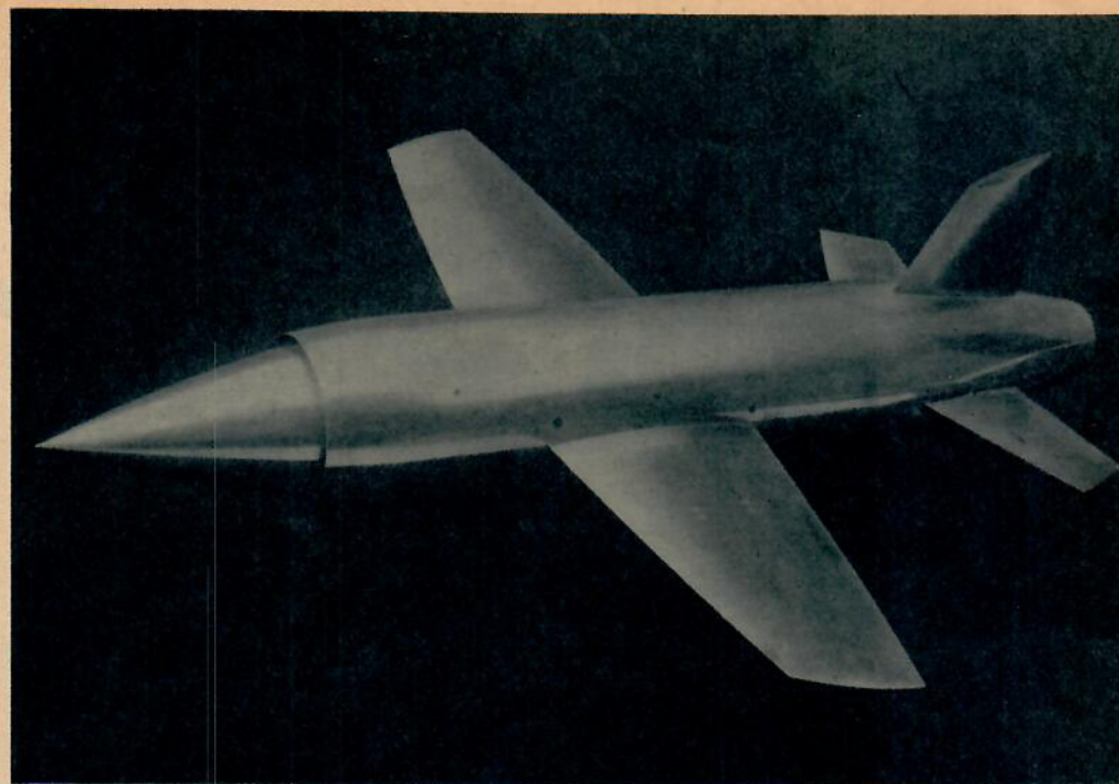
För att göra försök vid överljudshastigheter har engelsmännen byggt 24 flygplansmodeller skala 3:10 av Miles M 52.
