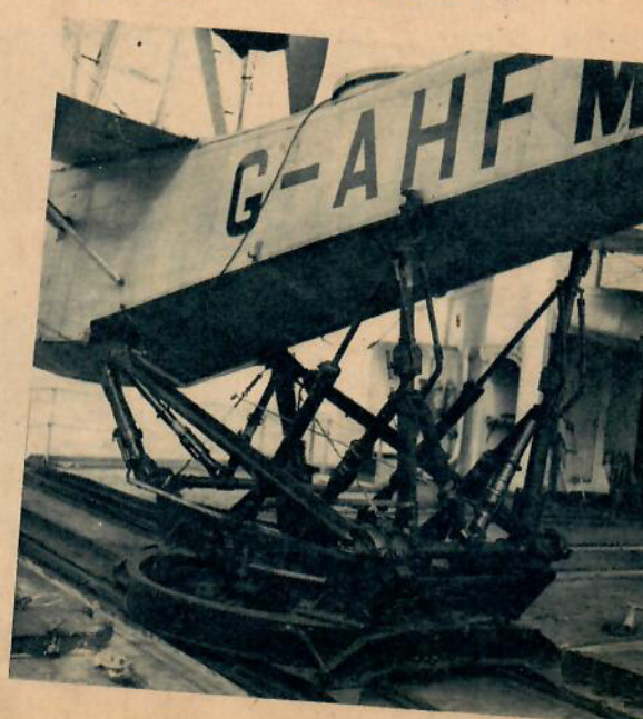
Nedan: En närbild av den kraftiga katapultvagnen, med vilken planet skjuts ut från valbåten.
