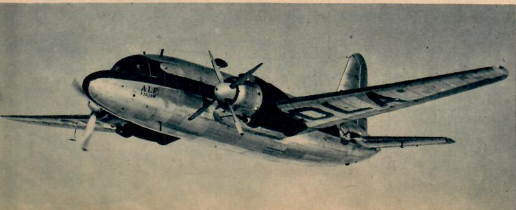
DDL:s första Vickers Viking »Alf Viking» under en provtur med vänstermotorn stoppad och den fyrbbladiga propellern flöjlad. Sammanlagt fem plan av denna typ har beställts av DDL.
