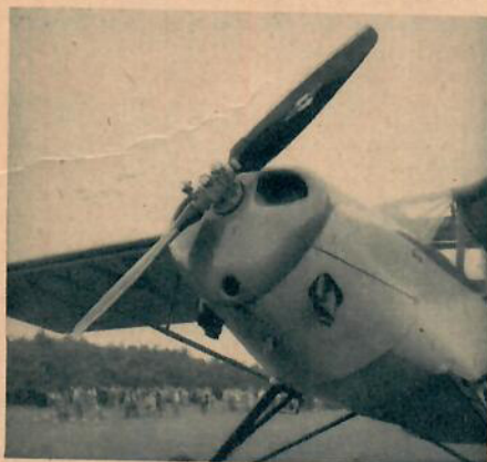
KZ-VII:an kommer att utrustas med omställbar propeller av typ Aeromatic.
