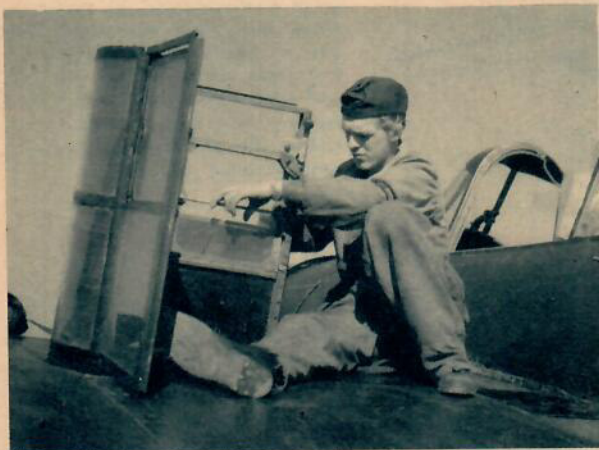
Vid ekoradioövningar flyger piloten under fullständig »mörkläggning». Här monterar korporal JAN NYLÉN bort täckplåtarna för kabinfönstren efter en övning.
