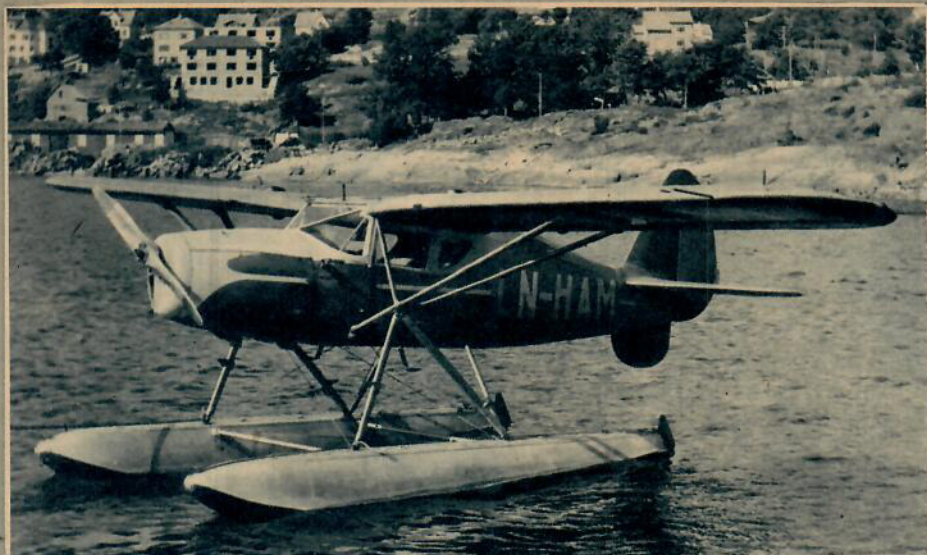
Ett norskt taxiplan av typ Faltchlld UC-61K tillhörigt A/S Lufttransport i Aalesund. Planet är utrustat med helmetallflottörer, vilka konstruerats och byggts av Norsk Flyindustri A/S på Fornebu.
