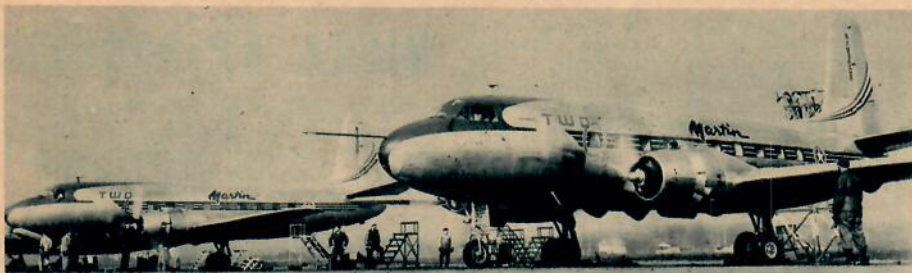
En bild av de två första flygplanen av den nya snabba amerikanska trafiktypen Martin 2-0-2 som kan bära 36—40 passagerare med en marschfart på 430—450 km/t. Provflygningen av det första planet som inte är någon prototyp i vanlig bemärkelse utan det första serieexemplaret ägde rum i slutet av november och det andra flygplanet var i luften redan den 28 januari.
