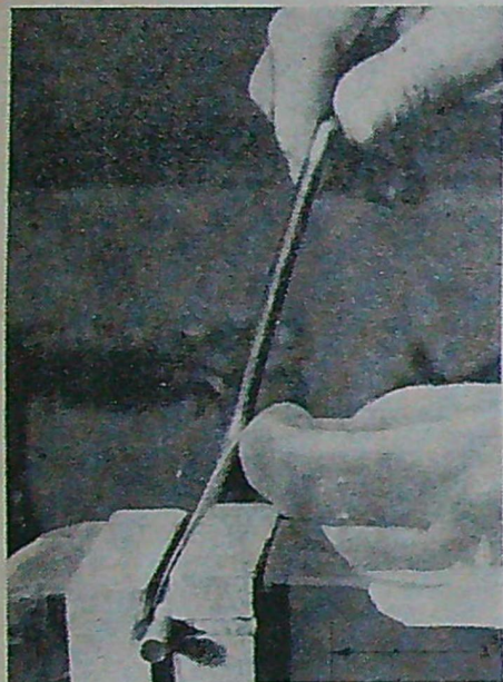
Lindning av fjäder med tillhjälp av en tvärborrad pinne och träklotsar fastspända i skruvstycket.
