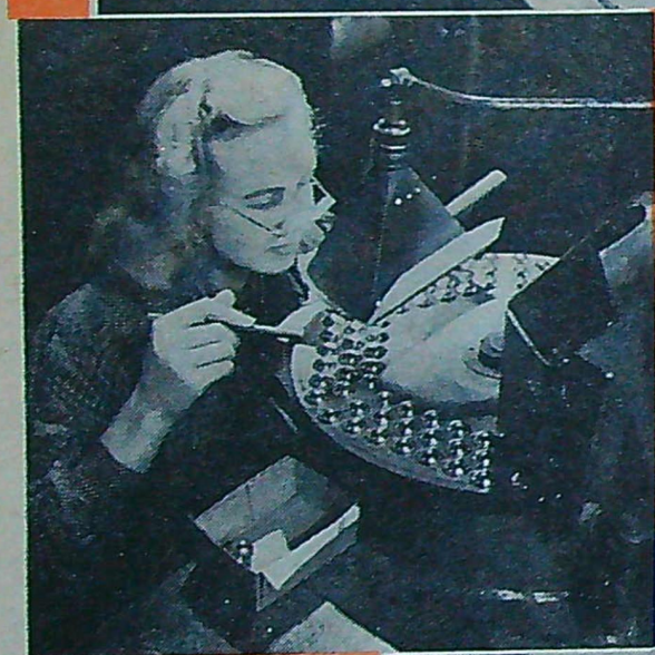
Bilden t. h. och ovan skulle kunna ges ru- briken. Då och nu. T. h. är en arbetarska under företagets tidi- gare år sysselsatt med att utan dagens hjälp- medel avsyna kulorna. Ovan har vi samma process i dag. Ku- lorna matas automa- tiskt ned i hålen på den runda skivan och får under dennas rota- tion sakta passera un- der ljusen från lampan.
