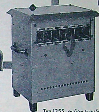
Typ 1355 en liten transformator med hög verkningsgrad och låga strömkostnader, avsedd för varierande svetsarbeten med elektroder upp till 3,25 mm. Svetsströmmen kan regleras mellan 20 och 135 A.
