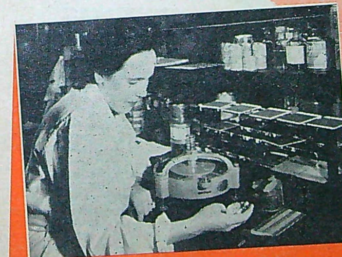
En bild från ett av Beckers kontrolllaboratorier, där flitkan arbetar vid en apparat, som bestämmer en färgs flytningsförmåga.
