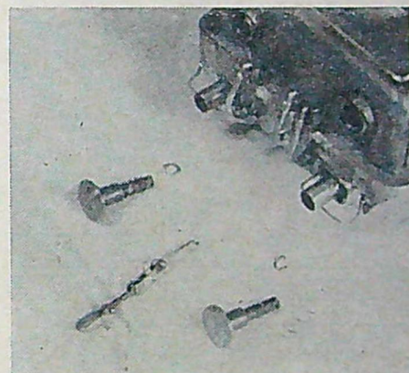
Nu gäller det endast att skjuta in buffertar och koppel på sina platser och fästa dem på buffertplankans baksida. Nedan ses en del av det färdiga loket i fågelperspektiv.
