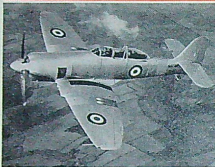
Ovan: Boulton Paul Balliol med sin 1 200 hk Merlin-motor har ungefär samma prestanda som mellankrigsplanens attackplan. Nedan: Royal Navys övningsplan Hawker Sea Fury T.Mk 20. Motorn är en Bristol Centaurus 18. Två 20 mm automatkanoner är inbyggda i vingarna.
