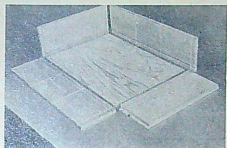
Lådkonstruktionen. Spåren är 7 \times 5 mm. Spännet vid ändarna är \frac{1}{2} \times \frac{3}{4} ". Bottnarna är av furuplywood.
