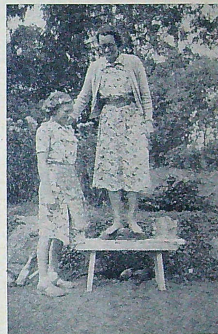
Ett bevis på hållbarheten. Konstruktörens hustru står ovanpå överdelen utan att den faller illa av belastningen.
