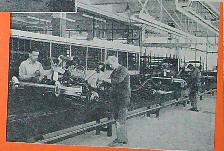
Ovan ett karosseri passerar en sprutbox där det får grundfärg innan det fortsätter in i torkugnen. T. h. växer bilarna fram på sammansättningsbanan.
