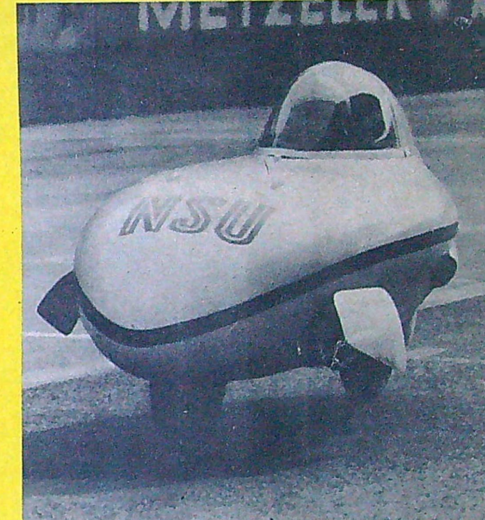
För att fordonet skall kunna hållas upprätt sedan det slutat rulla måste man stöda det med fötterna. Dessa kan stickas ut genom fällbara luckor som påminner om landställsluckor på ett flygplan.
