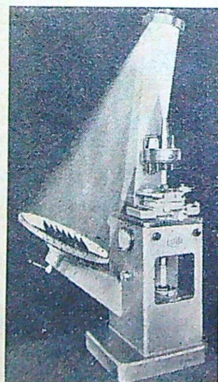
Ovan: Så här enkelt är det att använda minifonen, trådlös inspelningsapparat i kameraformat. Obs. mikrofonen i högra handen! Nedan: Stor profilprojektor av Leitz' fabrikat.
