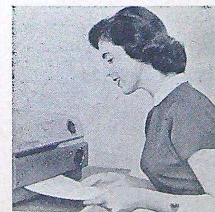
På fyra sekunder får man en kopia med den här kopieringsmaskin, som visades på mässan. Metoden bygger på papperets värmekänslighet. När papperen automatiskt förs över en infraröd ljuskälla, tränger värmestrålarna genom kopieringspapperet, men inte originalets text eller illustrationer, som bildar en mycket varm schablon, vilken i sin tur påverkar prepareringen i kopieringspapperet så att text och bild överförs.
