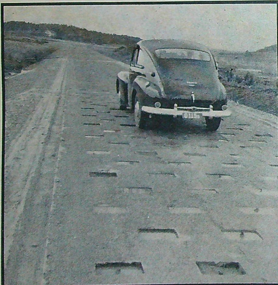
En splitter ny PV 444, som ska offras för olika prov, rullar fram på skakbanan (ovan). Längst upp t. v. civilingenjör Rune Andersson från Volvos laboratorium har hand om protokollet över proven. Detalj av skakbanan längst upp t. h. Man ser de nedsänkta plåtlådorna i vilka gjutjärnsblock av två storlekar placeras. T. h. en översiktsbild över det 30 hektar stora området på Hisingen, där Volvo så småningom ska få alla sina provbanor.
