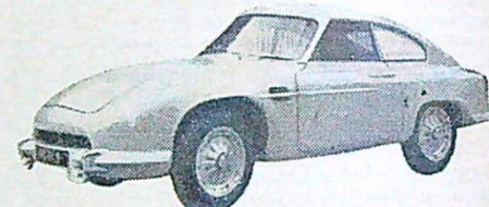
Franska D. B. har en tvåcylindrig s. k. flattwin-motor på 850 cc och kan tack vare låg vikt, 500 kg, komma upp i 155 km/tim.
