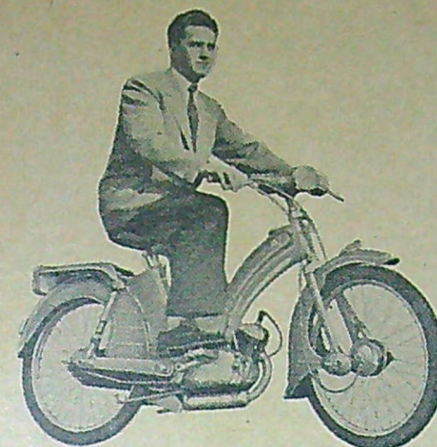
Ovan: Victoria Vicky MS 51 har vidareutvecklats ur fjolårets kända och omtyckta Vicky-modell. Ny är bakhjulsfjädringen, den in-kapslade kedjan, styret med "instrument-bräda", verktygsåldans placering m. fl. detaljer.
