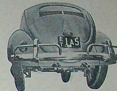
Volkswagens typiska akterv. Den individuella fjädningen ger denna kraftiga toe-in-vinkel vid en kraftig uppfjädning. Denna upphängning ger dock vagnen egenskaper som kan jämföras med de stora bilarnas.
