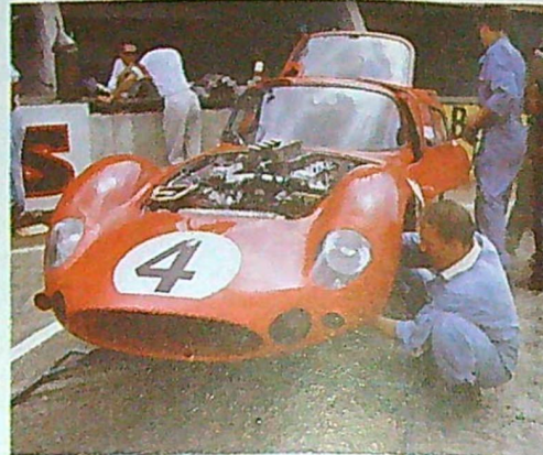
Denna magnifika experimentmodell från Maserati med motor på 4.000 cc hade enorma fortresurser men sämre väghållning. Motorn trasade också.
