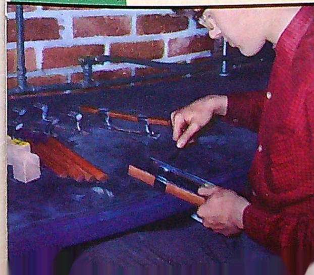
Förkromningen är klar. Korspollaren skall slutgiltigt monteras med sin trästav av ädelträ. En fördel med dessa pollare är att de görs av sådant material att de kan omförkromas. Överst monterad på plats. En sådan pollare kan även användas för grova linor.
