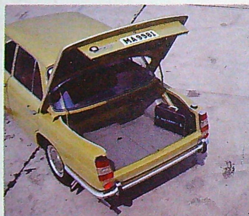
Bagageutrymme är mycket välplanerat och rymligt. Reservhjulet ligger under golvet. Huven fjäderbelastad.
