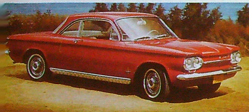
Corvair Monza Club Coupé av 1963 års modell finns numera med kompressormotad svansmotor, som ger 150 hk, eller man kan nöja sig med en vanlig drivkälla på 102 hk. 4-växlad helsynkroniserad eller automatlåda. I Amerika finns flera valmöjligheter både i fråga om motor och växellåda.
