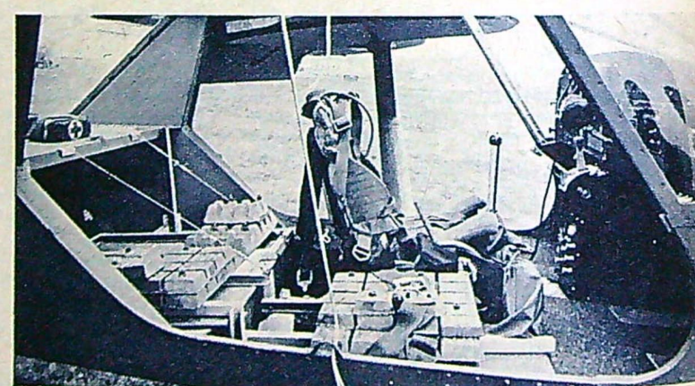
Under provflygningarna är Vipan fullastad med bly. Så gott som alla prov måste nämligen göras med ett maximum av belastning.
