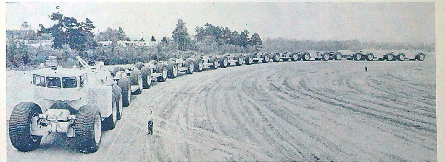
Världens längsta transportfordon med gummihjul anses denna 170 m långa amerikanska "armétraktor" vara. Däcken är drygt en meter breda och diametern är tre meter. Fordonet är avsett att främst användas i polar- och ökenområden. Lastkapaciteten är ungefär lika stor som den för 60 vanliga 2,5 tons lastbilar.
