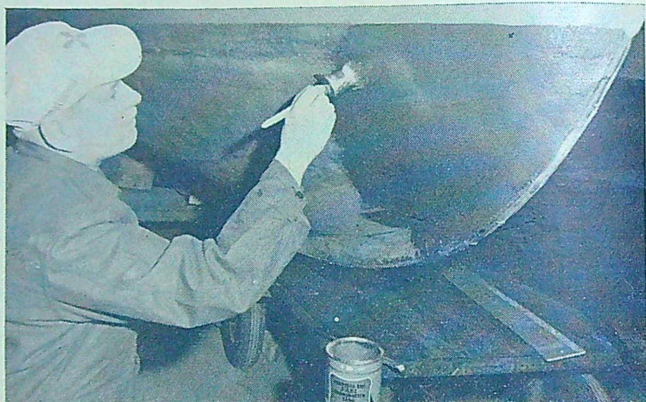
Efter impregnering, tätning och strykning med bottenprimer målas botten med beväxningsskyddande färg. Här stryks första omgången bottenfärg. Den andra och sista strykningen utförs strax före sjösättningen.
