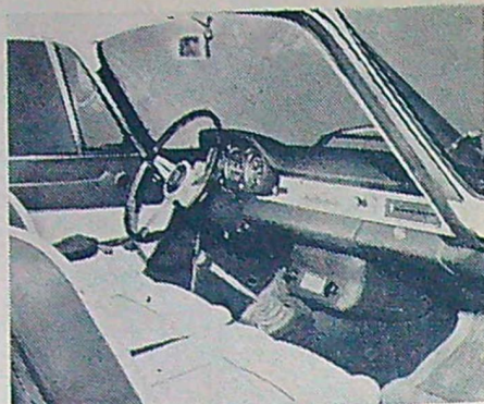
Alfa Romeo tar på nytt upp sexcylindriga motorer på sitt program. Hela serien av Alfa Romeo 2000 i olika utföranden får nu den nya sexcylindriga 2,6-litersmotorn i stället för den tidigare fyrcylindriga på 2 liter. Övan Interiör och motor i nya 2600 Sprint på 145 hk. Karossen är gjord av Bertone.
