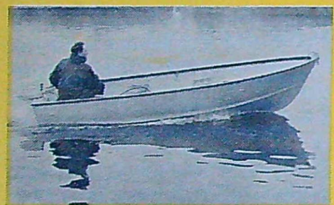
SELFLEET CASINO, som användes för förbrukningsprovet, är tillverkad av glasfiberarmerad plast och har måtten 4x1,60 meter. Vikten är ca 100 kg och båten kan användas med motorer på upp till 25 hk. Fyra personer får god plats i båten, som är belastningstestad med hela 600 kg last. Generalagent: N. K. Kristensson, pris 1 780 kronor.
