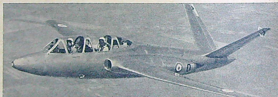
Macchi MB 323 var ett av de skolplan, som testades av svenska flygvapnet såsom tänkbart för våra förhållanden. Liksom i Magistern sitter föraren och eleven i tandem, ett arrangemang, som blir allt mera ovanligt.
