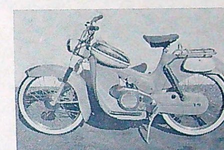
TOMOS MOPEDSKOTER. Motor: Tomos — 2-växlad — handväxel — kickstart — bromsljus. Fjädring: teleskopgaffel fram — swingarmgaffel bak. Tank: 5,5 liter. Riktpris: 1 175 kr.
