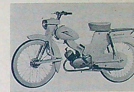
MUSTANG SPORT. Motor Zündapp — 3-växlad — kickstart — fotväxel — bromsljus. Fjädring: svängarmgaffel fram — swinggaffel bak. Tank: 5,5 liter. Riktpris: 1 150 kr.
