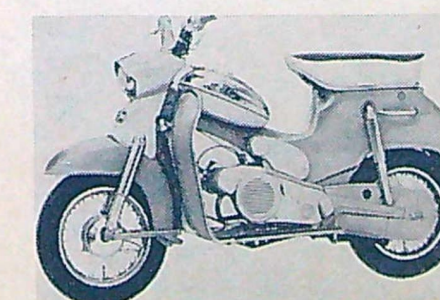
PUCH ALABAMA. Motor: Puch — 3-växlad — handväxel — kickstart — bromsljus. Fjädring: swingarm med teleskopstötdämpare. Däckdimension: 12"X3.00". Vikt 68 kg. Riktpris: 1 295 kr.
