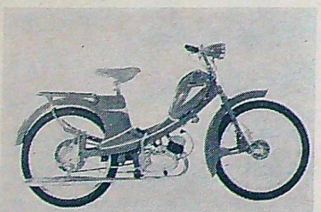
HUSQVARNA STANDARD. Motor: Husqvarna — 2-växlad — fotväxel — kickstart — bromsljus. Fjädring: Teleskopgaffel fram — svängarmstyp bak. Tank: 7 liter. Riktpris: 1 095 kr.
