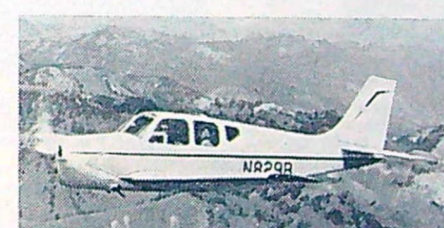
Beechcraft Debonair kostar fritt fabrik i USA ca 116 000 kr. Detta plan är fyrsitsigt och spännvidden är 9,6 m och längden 7,6 m. En 225 hk Continental-motor ger en marschfart på ca 296 km/tim.
