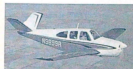
Bonanza tillverkas av Beechcraft och är utrustad med en 260 hk Continental-motor, som ger en marschfart på 305 km/tim. Fritt fabrik i USA kostar planet 138 000 kr. Spännvidd 10 m, längd 7,7 m.
