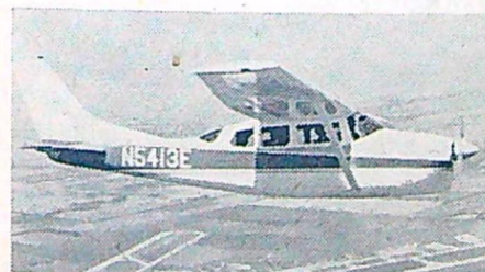
Cessna 210 har indragbart landningsställ och detta fyrsitsiga plan har en Continental-motor på 260 hk som ger en marschfart på 220 km/tim. Spännvidden är 11 m och längden 8,4 m. Priset är 150 000 kr.
