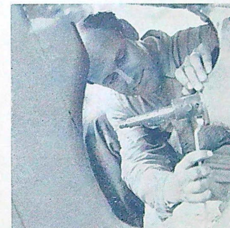
Kay Hansson drar här till propellerlagret på sin nybyggda TFA-kryssare. Det robusta rodröt består av ett stort antal sammanlimmade lameller av ek.
