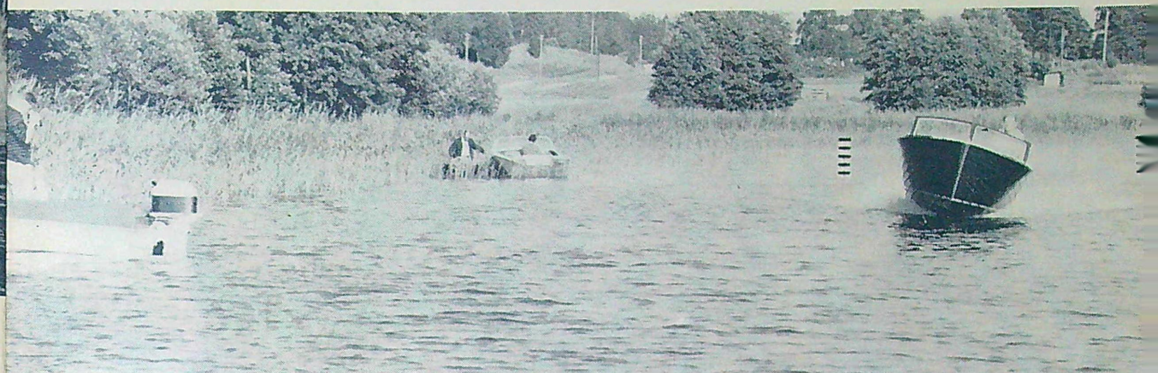
Speedy, Teknik för Allas populära sportbåt för ungdom, är avsedd att "flyga lågt" över vattnet och trivs därför inte särskilt bra i farter under 13-14 knop. Trots sin litenhet ger den vid låga farter ungefär samma svall som dubbelt så stora båtar. Vid provet kördes Speedy med en 8 hk Crescent Marin, men med en någorlunda tung person kräver båten minst 10 hk, varvid toppfarter på ca 20 knop och strax däröver kan nås. Se närmare i Teknik för Alla nr 14.
