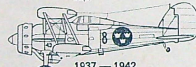
J 8 1937 — 1942 GLOSTER "GLADIATOR". Tillverkare: The Gloucester Aircraft Co Ltd, England. Motor: en 600 hk Bristol Mercury VI S2, 9-cyl. stjärnmotor. Spännvidd 9,85 m, längd 8,36 m. Toppfart 360 km/tim. Besättning 1 man. Beväpning 4/12,7 ksp.
