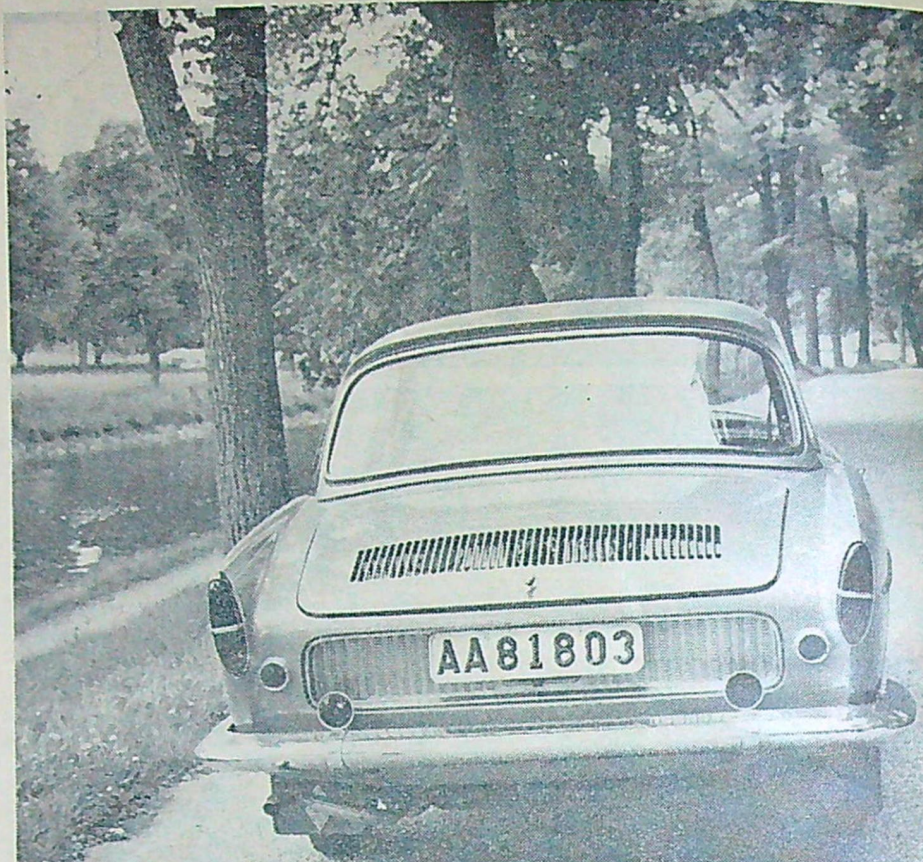
Att Renault Caravelle är en vacker bil är odiskutabelt. Den får nog anses vara en av de allra smakfullaste och stilrenaste i mellanbilsklassen. Såväl motorn som bensintanken är placerade bakom bakaxeln.
