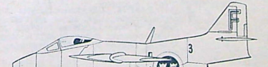
J 30 1948 — 1953 DH 98 MK 19 "MOSQUITO". Tillverkare: De Havilland Aircraft Co, England. Motor: två 1 655 hk Rolls-Royce Merlin 25, vatskeylda, 12-cyl. V-motorer. Spännvidd 16,51 m, längd 12,70 m. Toppfart 600 km/tim. Besättning 2 man. Beväpning 4/20 akan.
