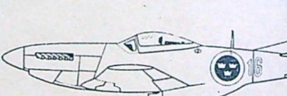
J 26 1945 — 1952 P-51 D MUSTANG. Tillverkare: North American Aviation Inc., Calif., USA. Motor: en 1 650 hk Packard Merlin (RR) V-1650-7, vatskeyld, 12-cyl. V-motor. Spännvidd 11,27 m, längd 9,83 m. Toppfart 695 km/tim. Besättning 1 man. Beväpning 6/12,7 ksp.
