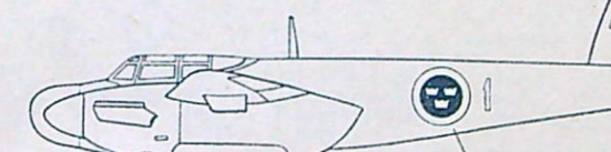
J 30 1948 — 1953 DH 98 MK 19 "MOSQUITO". Tillverkare: De Havilland Aircraft Co, England. Motor: två 1 655 hk Rolls-Royce Merlin 25, vatskeylda, 12-cyl. V-motorer. Spännvidd 16,51 m, längd 12,70 m. Toppfart 600 km/tim. Besättning 2 man. Beväpning 4/20 akan.
