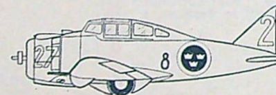
J 9 1940 — 1951 SEVERSKY-REPUBLIC ED-1. Tillverkare: Republic Aviation Corp., N. Y., USA. Motor: en 1065 TWC3-G (Pratt & Whitney), 14-cyl. stjärnmotor. Spännvidd 10,97 m, längd 8,17 m. Toppfart 520 km/tim. Besättning 1 man. Beväpning 2/7,9 + 2/13,2 ksp.
