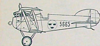
J 1 1919 — 1930 PHOENIX 122. Tillverkare: CVM, Malmöslätt, Sverige, Phoenix-Werke, Wien, Österrike. Motor: en 185 hk BMW, vattenkyld, 6-cyl. radmotor. Spännvidd 9,80 m, längd 6,85 m. Toppfart 170 km/tim. Besättning 1 man.
