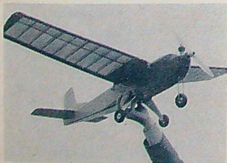
Hegi Styrofix är knappast en vacker modell, men den är i stället synnerligen lätt att bygga. Kroppen är av cellplast som förstärks genom balsaklädsel.
