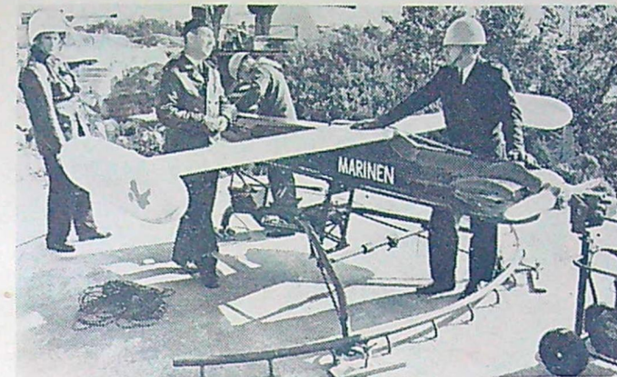
Marinen har nyligen inköpt målrobotar från England. De skall vara billigare än de gängse bogserade målen. Dessutom slipper man risken att det bogserande planet skall träffas. Några data: längd 3,75 m, spännvidd 4,10 m, fart 350 km/tim, flygtid ca 2 tim, högsta höjd ca 6500 m. Motorn är en fyr cylindrig tvåtakare på 70 hk. Roboten styrs med radio. Den startas med raketen och landas med fallskärm. Man räknar med att den skall hålla för 15 nedskjutningar.
