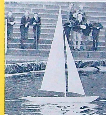
En radiostyrd modellbåt visades på Modellsportens Dag. Styrningen sker genom att roder och storsegel påverkas via radioimpulser. Det intressantaste är här kombinationen av segling och radioteknik.
