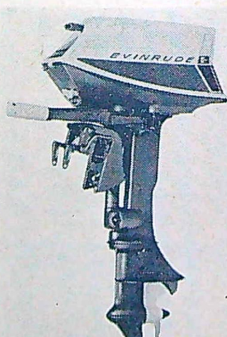
Evinrude Fisherman på 5,5 hk får i 1963 års modell en ny, effektiv insugningsljuddämpare, som sänker ljudnivån med 15 proc., samt en motorkåpa som ger bättre dämpning av ljudet.
