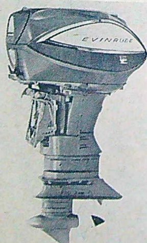
Evinrude Starlite ger 75 hk och bland finesserna märks elektriskt, knappmanövrerat backslag, växelströmsgenerator och signal för tändning. Radiostörningsskydd finns som tillbehör.
