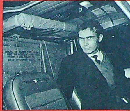
Comanchen tankar normalt 90 US gallons, vilket räcker för 270 mils flygning. De båda extratankarna, som tog hela det bakre passagerarutrymmet i anspråk, gav ytterligare 150 US gallons tankvolym med 350 mils extra flygväg.
