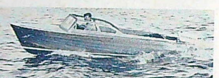
Ejden heter en av AB Gösta Bergs campingbåtar. Den är klinkbyggd i mahogny på ekspant. Utrustad med teleflexstyrning och bekväm, öppningsbar vindruta. Gör 24 knop med 43 hk Scott-motor. 5 640:-.
