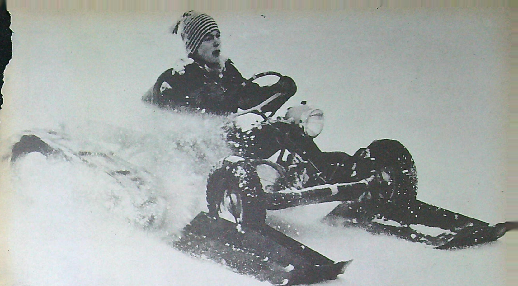
Arne Franssons "Snö-Geting", här rattad av sonen Lars, är onekligen en intressant konstruktion och kanske lösningen på ett besvärligt problem. Vagnen är i sig själv billig och "snöaggregatet" behöver heller inte kosta många kronor, eftersom vem som helst som är en smula händig kan klara jobbet. Motorn är på 200 cc.
