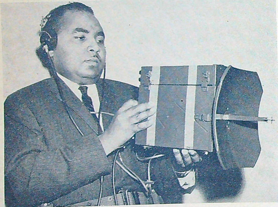
En radarstation i myggyktklass ser ni på bilden ovan. Den har konstruerats för att användas av amerikanska fältförband vid operationer i mörker och dimma. Räckvidden är två km och priset under 10 000 kr.
