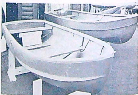
AB Tegea visade ett par båtar av mjuk termoplast, ett material som är mycket segt och elastiskt. Pioner IV är 2,8 m lång, 1,1 m bred och väger 55 kg. Kan förses med motor på upp till 5 hk.
