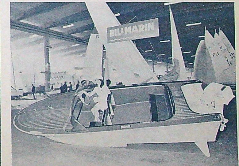
BM-Hydrocraft är 5 m lång och 2 m bred och kommer från AB Bil och Marin. Denna båt är en stegbåt med aktertunnel, men avsikten med bottenformen är inte att vinna fart utan att uppnå mjuk gång. Planar med 25 hk motor och fem ombord.
