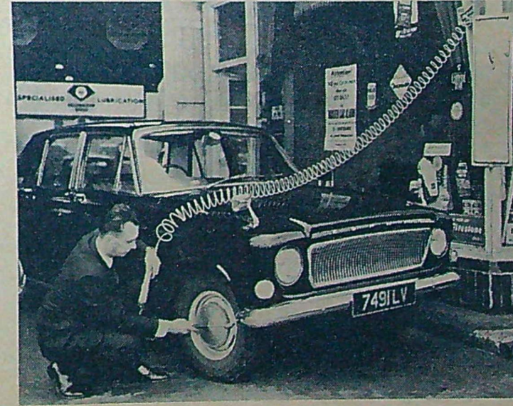
En slang som rullar upp sig själv på samma sätt som en sladd på en modern telefonapparat är den senaste nyheten på servicestationer. Slangen, som döpts till Recoil, kan dras ut och bli 20 gånger längre än den är i hoprullat skick.
