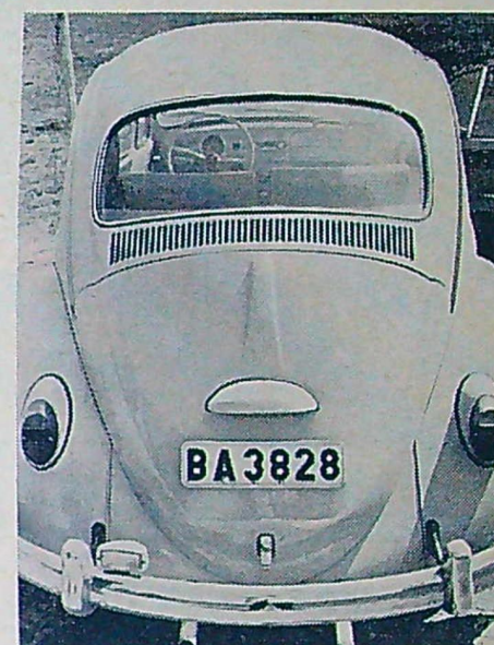
Bakrutan är nu så stor att ingen del av karossen skymmer den sikt man har via backspegeln. Stötfångaren bak är förmodligen lika lätt att knäcka som på tidigare modeller.
