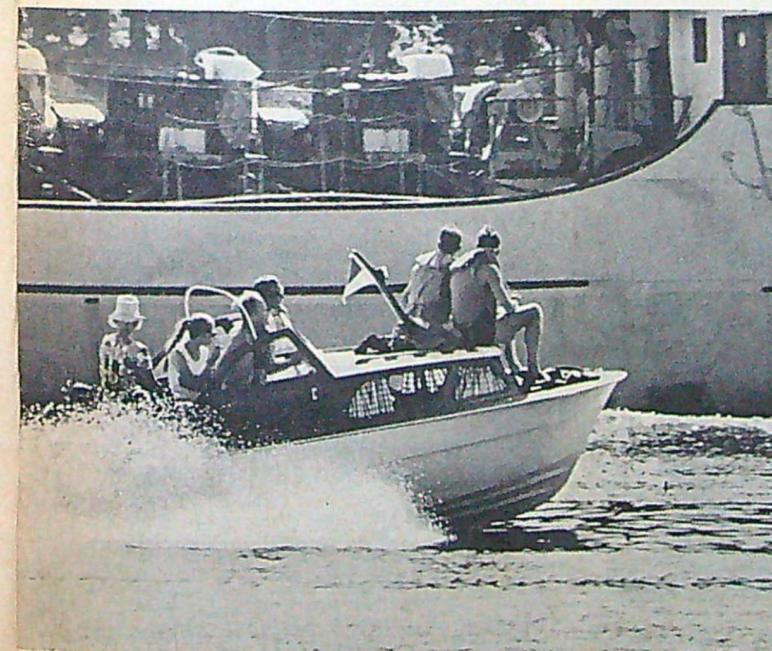
Det är farligt att sitta på fördäck på en snabb båt. Flytvästen skyddar inte om den som faller överbord sugts in mot propellern. Pojkarna på fördäck skymmer f ö även sikten. Risken är särskilt stor i detta fall då båtföraren går farligt nära det stora motorfartyget. Motorbåten kommer att göra en kraftig överhaling när den kommer i fartygets bogsvall.
