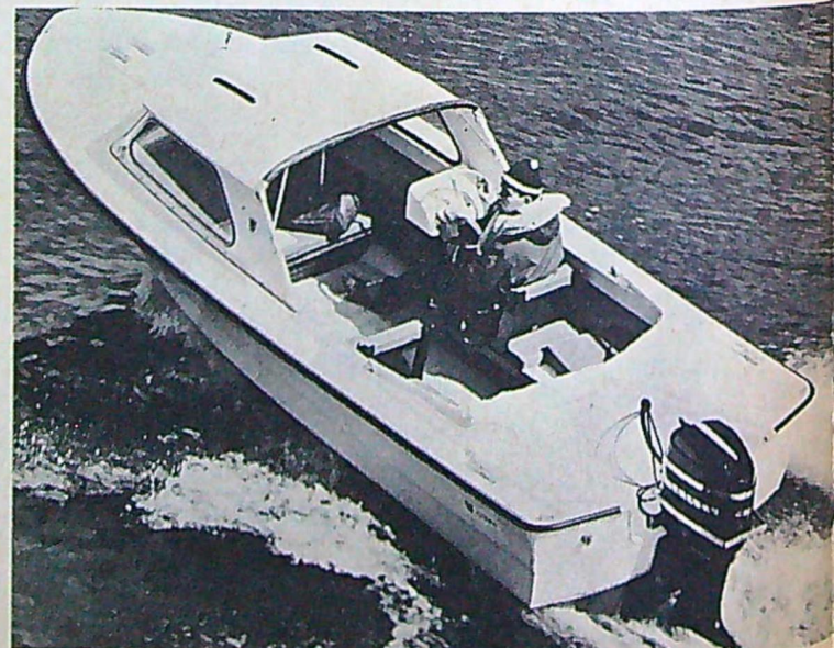
I aktersittrummet finns två långsgående bänkar som ev kan användas som barnkojer. Styrpulten är placerad midskepps åt styrbordssidan.
