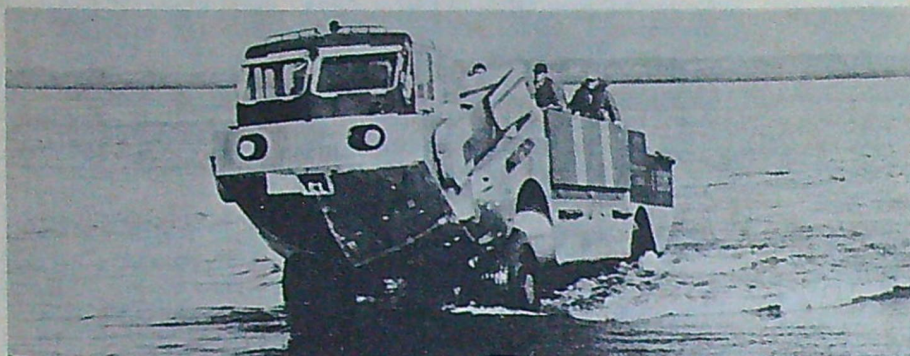
När LVHX-1 närmar sig land fälls hjulen ut och fordonet rullar vidare som bil.
