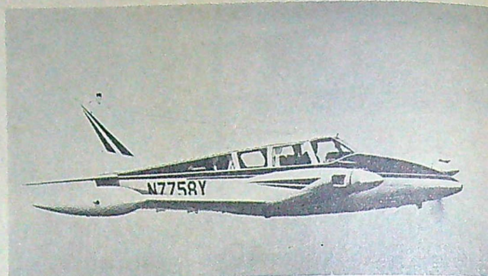
Piper Twin Comanche B kommer 1966 med kompressormatade Lycoming-motorer på 160 hk. Inbyggt syrgassystem och vingtankar ingår i standardversionen.
