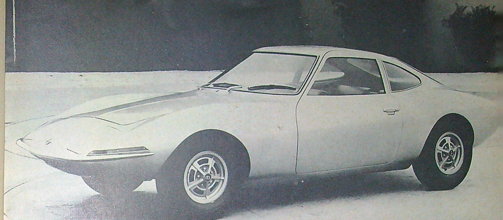
Experimentvegnan Opel Grand Tourisme Coupé är byggd för utprovning av fjädringar, motorer, karosseriform, styrsystem och bromsar på Opels provbana i Dudenhofen. GM i USA har byggt en snarlik kaross på Corvair underrede.
