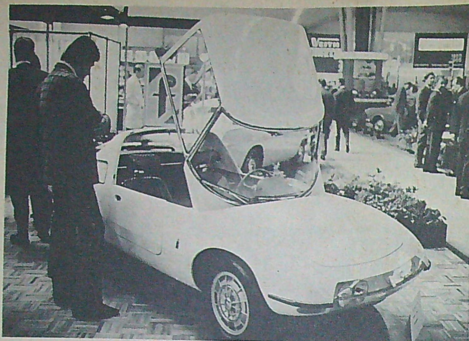
Fiat Abarth Coupé Speciale due posti är lätt att komma i genom att tak, vindruta och sidorutor hänger ihop i en enhet som lyfts upp, samtidigt som det finns dörrar i sidorna som vanligt.
