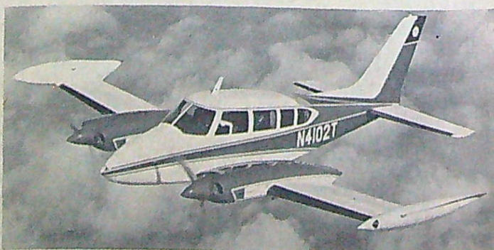
1966 års Cessna Skyknight får kompressormatade motorer som i hög grad förbättrar planets prestanda, inte minst på hög höjd.
