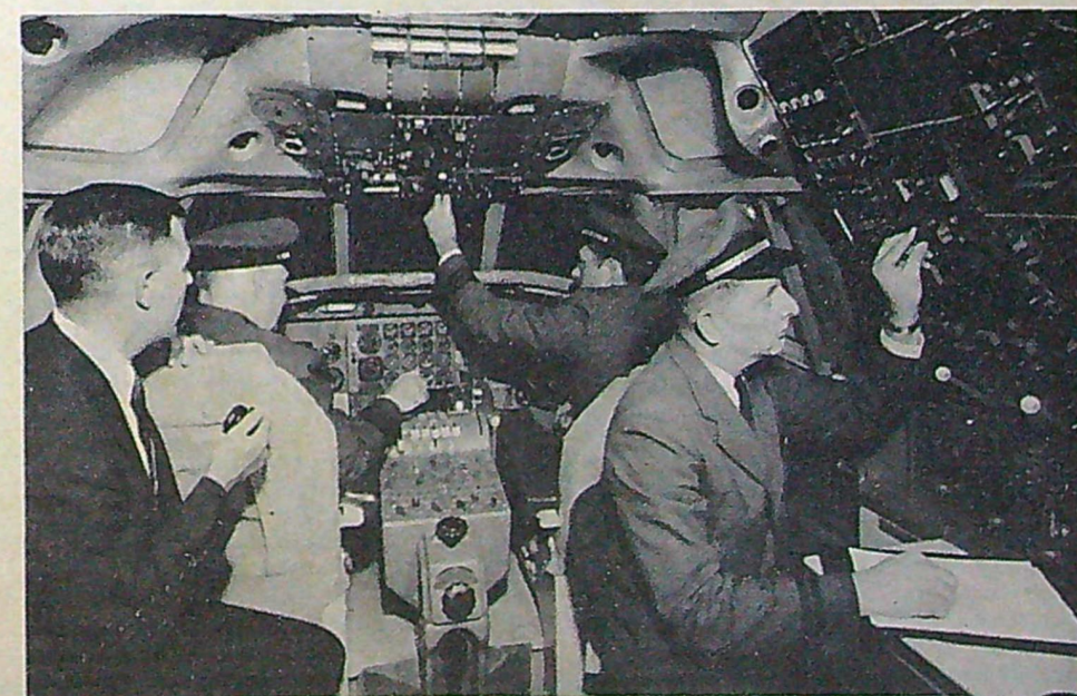
Ett flertal simulatorer står till förfogande för utbildning på marken. Detta är en DC-8-simulator som används vid United Air Lines' anläggningar i Denver.
