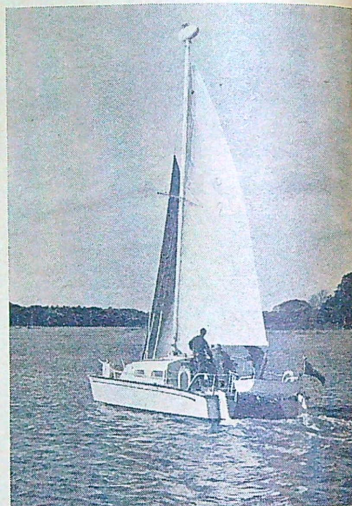
Katamaranen Prout har samma längd som Atlanta men har som dubbelskrovsbåt påfallande goda utrymmen ombord. Det finns fyra fasta kojor och välutrustat pentry. Prout har centerbord.
