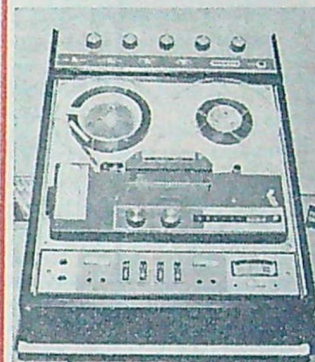
Truvox-bandspelaren PD99 visas här sammankopplad med förstärkaren TSA 100 av samma fabrikat. Den senare kan även ställas med fronten framåt.
