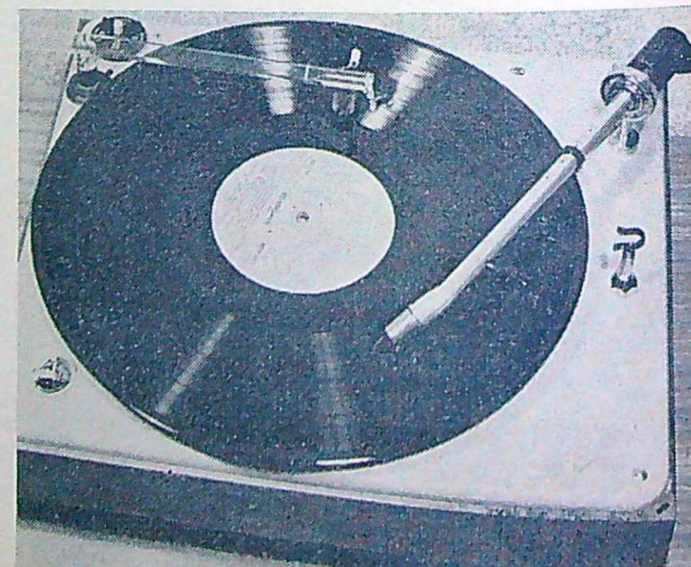
Dust Bug är en annan skivrengöringsanordning — den rengör skivan medan spelning pågår och minskar även den statiska elektriciteten om den före påläggning fuktas med antistatvätska. Pris 10:50 hos ELFA.
