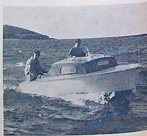
Sea-Shanty är en liten midgetkabinbåt — 4,2 m — av plast. En motor på 1,5 hk ger 5 knops fart. Två sovplatser finns. Kostar i England 6 400:—
