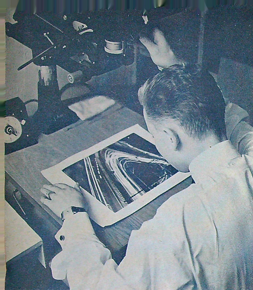
Negativet har lagts in i förstöringsapparaten och skärpan ställs in. Man använder som här en bit vit kartong på vilken bilden projiceras. Sedan man ställt in bilden så att den är fullkomligt skarp, bländar man av, svänger för rödfiltret och lägger förstöringspapperet på plats. Om man önskar vita kanter på bilden använder man en avmaskningsram, som också har den fördelen att den håller papperet stadigt och plant.
