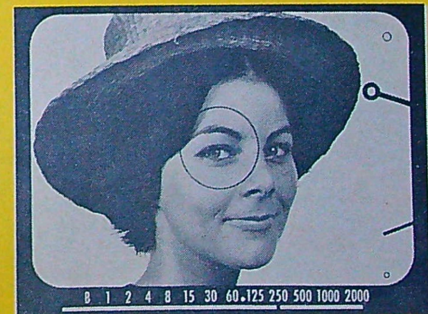
Det centrala mätfältet i sökaren innehåller över 13 000 mikropismor som överdriver den oskärpa som förorsakas av att man betraktar en motivdel som objektivet inte är skarpt ställt på (t v). Bilden till höger visar den rätta avståndsställningen.
