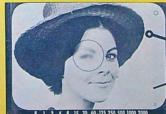
Det centrala mätfältet i sökaren innehåller över 13 000 mikropismor som överdriver den oskärpa som förorsakas av att man betraktar en motivdel som objektivet inte är skarpt ställt på (t v). Bilden till höger visar den rätta avståndsställningen.
