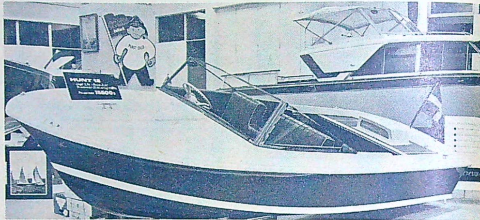
Ray Hunt är mannen bakom Bertram-båtarna och firma Peter Wessel i Stockholm har importerat ett antal Hunt-konstruerade sportbåtar. Den här exklusiva vattenskidbåten heter Hunt 18, mäter 5,70x2,30 m och är byggd i glasfiberarmerad plast. Den är avsedd för inutbordanregat och kostar 15 500:— utan motor.
