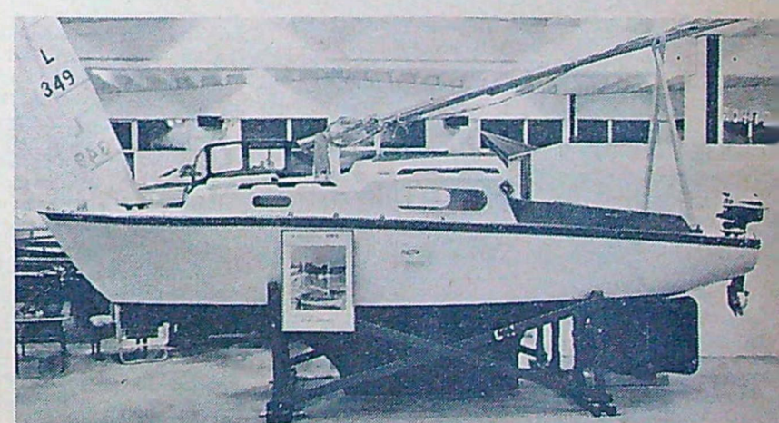
Aneshed visade också en engelskbyggd "familjeseglare" i glasfiberarmerad plast. Den mätte 5,90x1,95 m, hade en total segelyta på 14,4 m 2 och var försedd med lättmetallmast. Tre kojplatser. Pris med segel 11 580:—.
