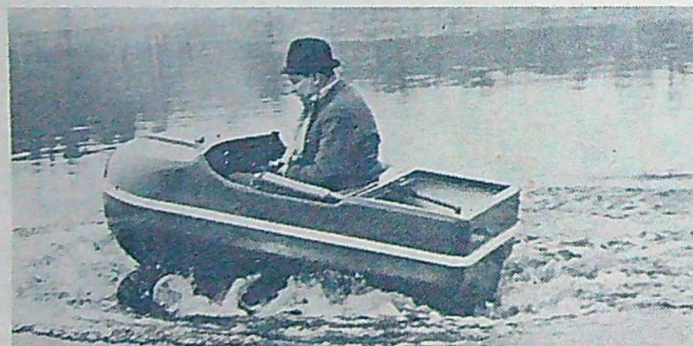
I sjön samverkar de sex hjulen och en liten vattenturbin till framdriften.
