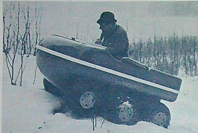
Där vägen tar slut tar Terra Gator vid. Den lilla amfibien kan både klättra, simma och vada. De sex hjulen, som alla driver, fördelar tyngden över så stor yta att amfibien lätt tar sig fram i lös snö, över kärr- och myrmarker.
