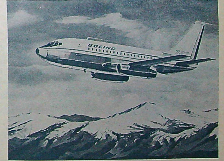
... och för att ännu så länge hålla sig till dessa, så ser ni på teckningen ovan en Boeing 737, avsedd för korttidsflyg. Det är ett tvåmotorigt plan som kan ta mellan 76 och 94 passagerare. Marschhastigheten blir ungefär 900 km/tim och den maximala räckvidden 1 100 km. Första provflygningen blir i november i år, om allt går enligt planerna.
