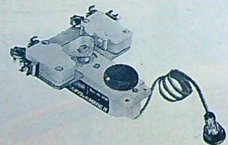
Från Graupner har också kommit en omspolnings-sats för elmotorer. Den kopplas till en Servoautomatic I eller II och kan också användas i samband med relativt stora elmotorer. Pris 18:75.
