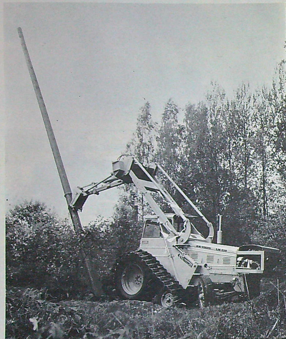
Till lastmaskinserien finns ett nytt enmansbetjänat stolpresningsaggregat. Bilden visar en LM 218 under resningsarbete.
