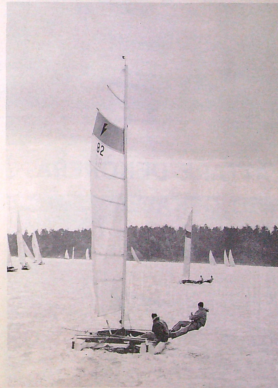
Även de små "kattorna" tävlar på de största båtarnas bana i Sandhamn. Här är en seriebyggd Thai 4. Den för 20 m 2 segel och mäter 5,33x2,44 meter. Vikten är bara 130 kg. Thai 4 har loggats upp till 25 knop och kostar med plastskrov ca 9 500:—.
