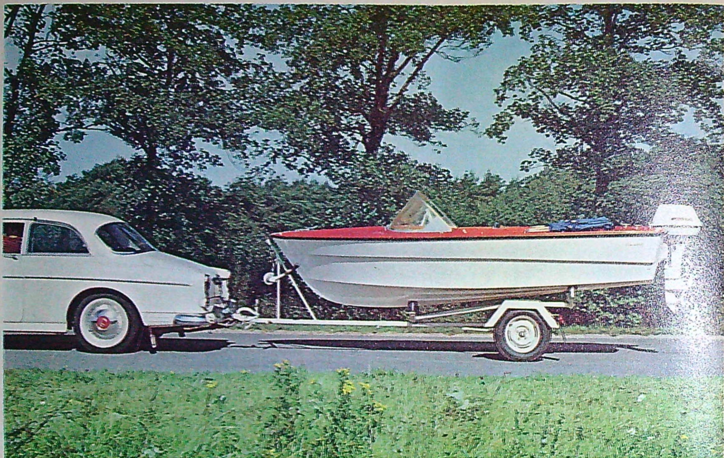
Båttrailern har löst båtplatsproblemet för många och öppnar också nya och intressanta möjligheter för båtutrustning. Det är dock viktigt att trailern verkligen passar båten och det förekommer därför s k "sjöpaket" där båt, passande trailer och motor säljs tillsammans. Vi ser här ett sådant exempel, Crescents sjöpaket omfattande Avant-sportbåt, trailer och snurra. Trailern har tjänstevikten 100 kg, är typbesiktigad för upp till 250 kg last och kostar 1 445.—.
