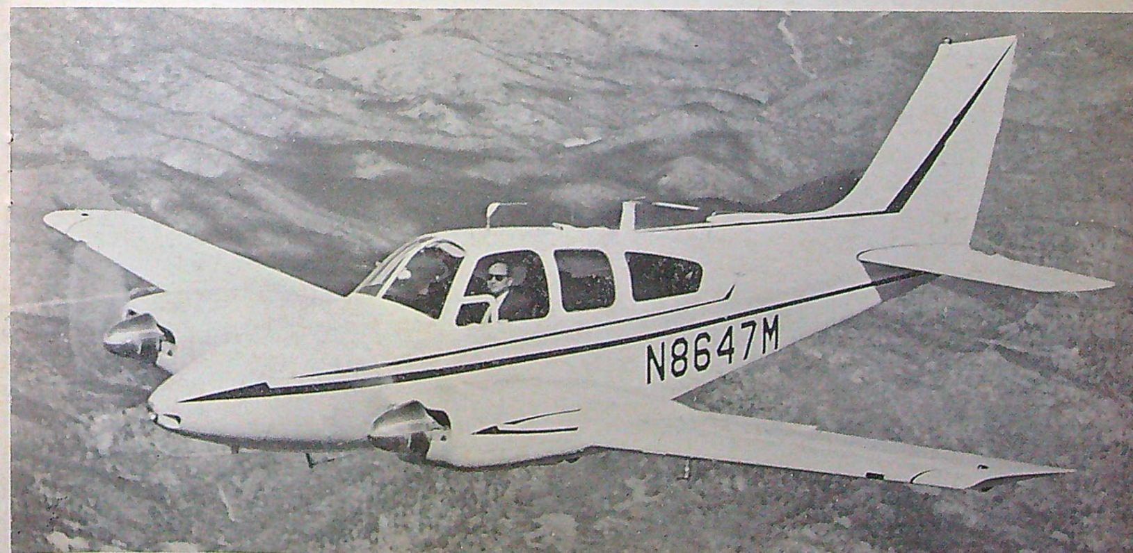
De två Continental-motorerna ger Baronen en toppfart på hela 390 km/tim och en marschfart på 2 100 m höjd och 75 procents motorpådrag på 370 km/tim. Flygplanet är mycket stabilt och lättflygt och tål dessutom att granskas, eller hur?
