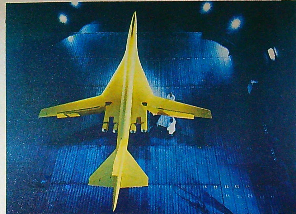
Vindtunnelprov med skalmodeller används i mycket stor utsträckning vid projekteringen av SST beträffar. Här monterar man en Boeing 733. Modellen är gjord av trä och man blåser här endast underljudshastigheter.
