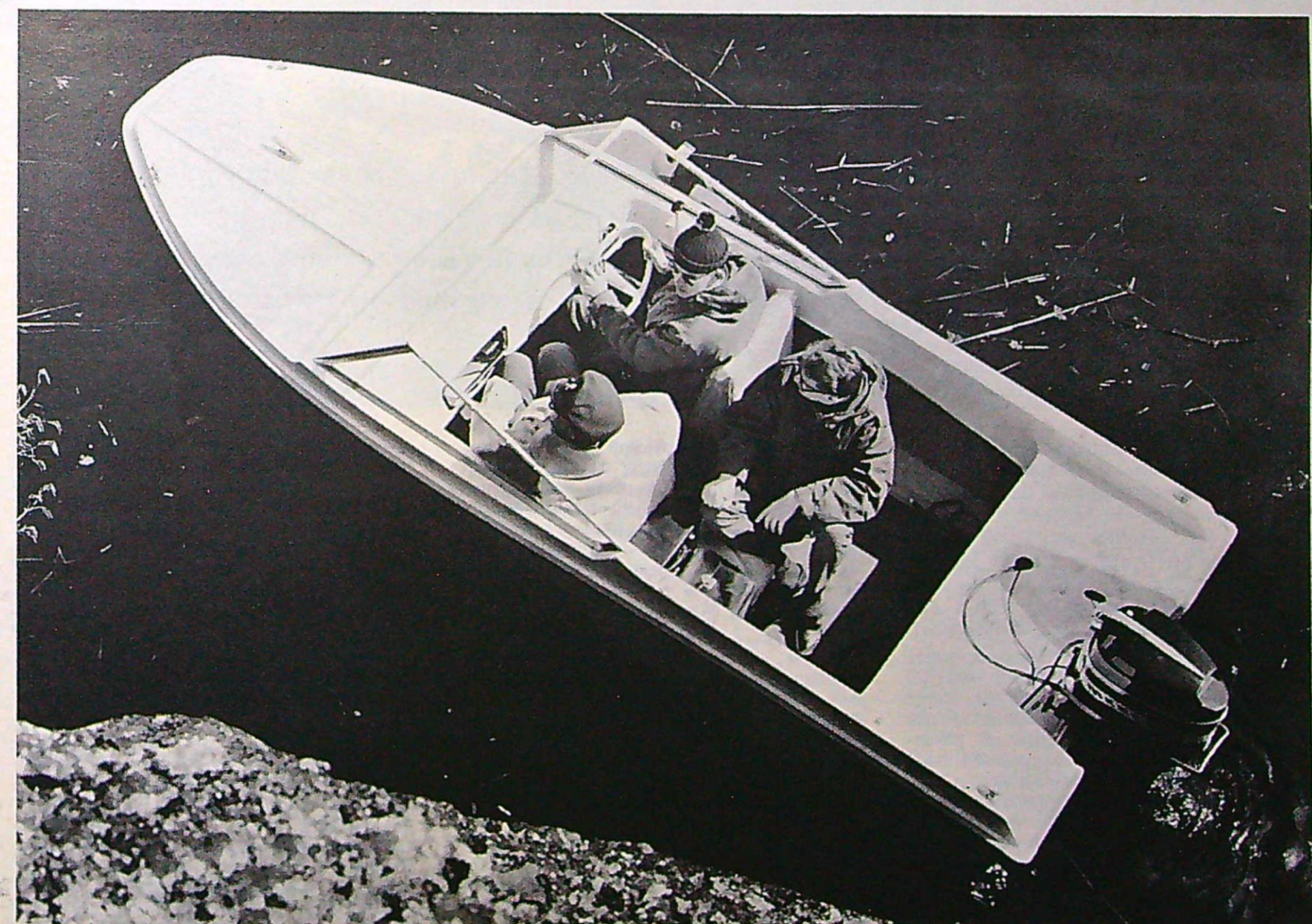
Sitttrummet i Rimini är 1,90 m långt. Förarstolen ger en sitt höjd på 0,29 m och båtens höjd från vattenytan till vindrutans överkant är 0,84 m vid stillaliggande.
