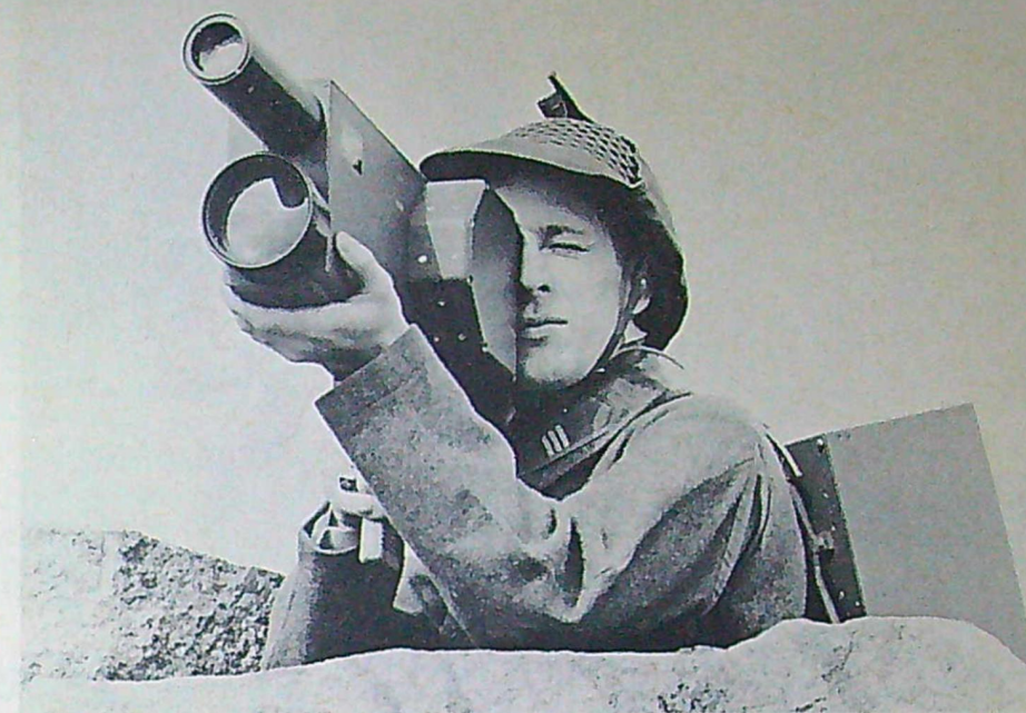
I första hand kommer rubinlaseravståndsmätaren att utnyttjas för militära ändamål. Dess vikt, 25 kilo, gör att den med lätthet kan skötas av en man.
