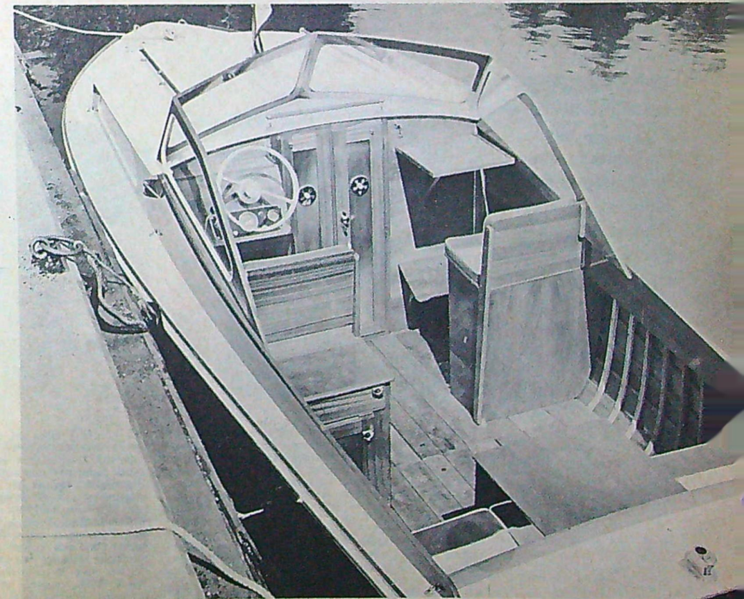
Vår översiktsbild över sittbrunnen visar förarplatsen samt navigatörens plats med nerfällbart navigationsbord. Fotplattan som syns vid navigatörens plats är kraftigt utförd och gör att sittställningen blir vilsam. Även vid förarplatsen finns en sådan fotbräda.
