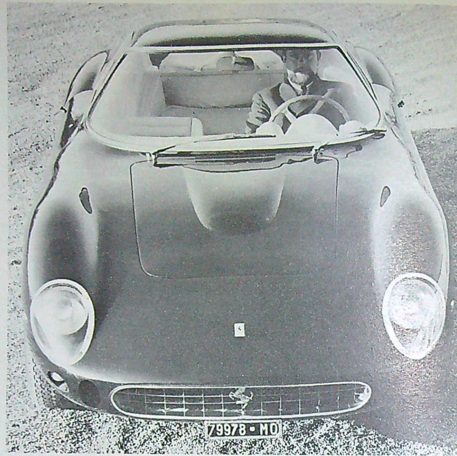
Under motorhuven döljer sig en vältrimmad treliters V-12:a på 300 hk. Med den nya karossen som ger ett lägre luftmotstånd än originalversionens når bilen en toppfart på 284 km/tim.
